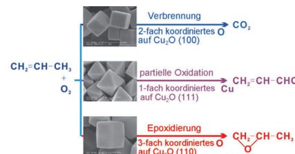
**Ansichtssache:** Die katalytische Oxidation von Propen mit  $\text{O}_2$  lieferte an  $\text{Cu}_2\text{O}$ -Oktaedern mit exponierten {111}-Kristallflächen bevorzugt Acrolein, an  $\text{Cu}_2\text{O}$ -Würfeln mit exponierten {100}-Kristallflächen bevorzugt  $\text{CO}_2$  und an rhombischen  $\text{Cu}_2\text{O}$ -Dodecaedern mit exponierten {110}-Kristallflächen einen größeren Anteil Propenoxid. Die aktiven Zentren dieser Reaktionen wurden identifiziert (siehe Schema).
